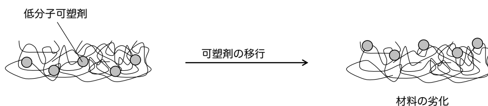
図7 低分子可塑剤の移行と材料の劣化
