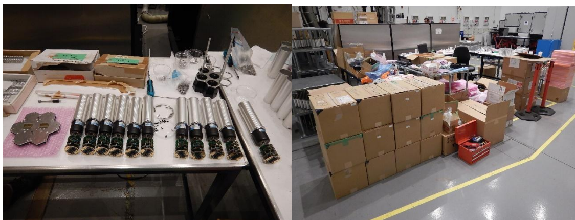
図 3.1 組み立て中の PMT module と、組み立てや Module QC を行っているエリア
