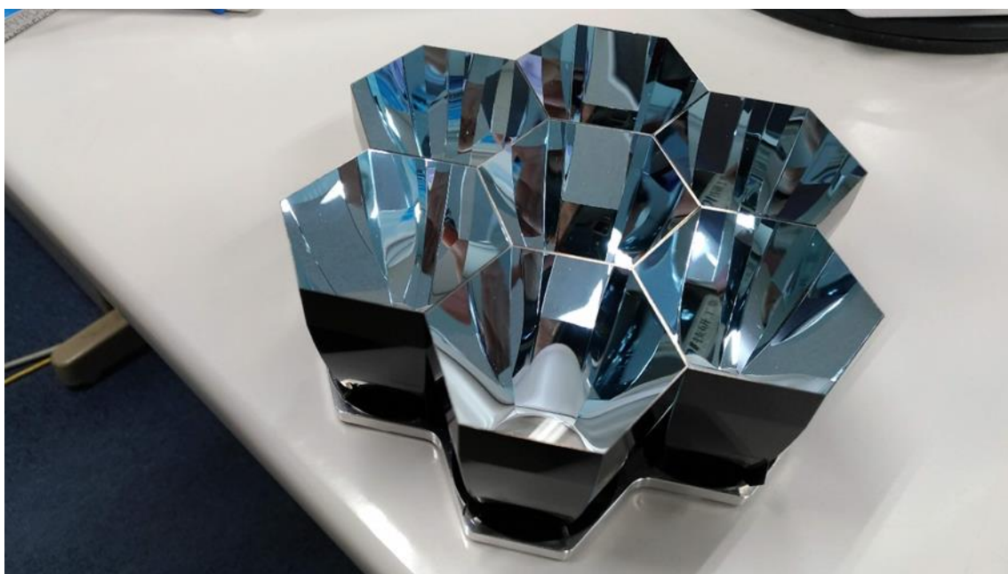
図 2.9 開発した PMT に取り付けられるライトガイド. 1つの module に 7 本の PMT が搭載され、このライトガイドを装着している。
