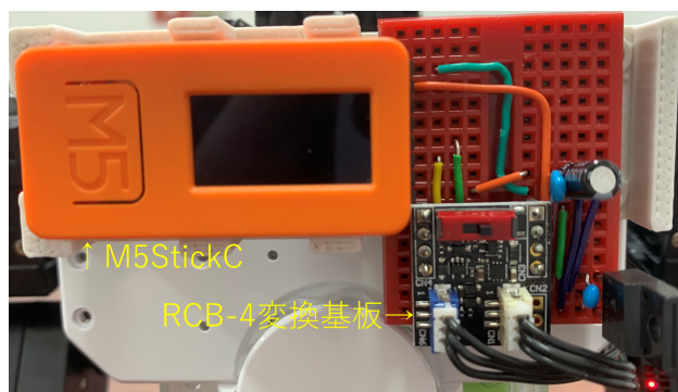
図 4: ロボット制御用の M5StickC および電気回路
