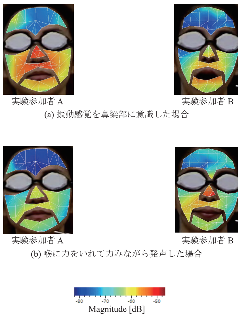
図 5: ハミング発声時の皮膚振動速度パターン
