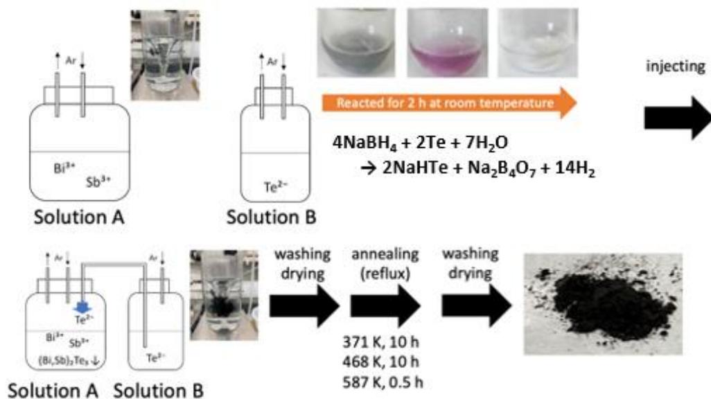
スキーム 1. 電荷補償反応を基調とした Bi<sub>2.0-x</sub>Sb<sub>x</sub>Te<sub>3.0</sub> (x = 1.5、1.6、1.7) ナノ結晶の合成プロセスを示す模式図
