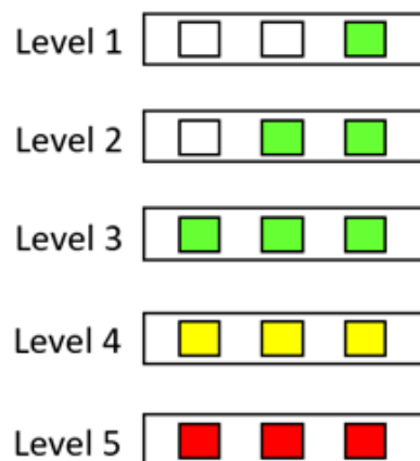
図 4.7: 振幅モードの LED の点灯パターン。Level 1～3 は緑色, Level 4 は黄色, Level 5 は赤色で発光する。発声中のストロー壁面振動の振幅が大きくなるにしたがって点灯数や色が変わる。
