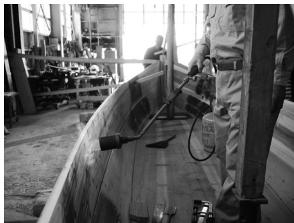
写真8 ハタ板の焼き曲げ 氷見 2010.4
